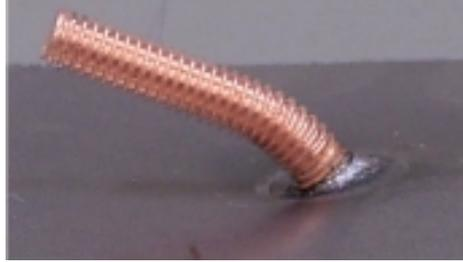
【スタッドボルトの曲がりや溶接部の母材破断が発生した状態】
